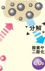
光触媒とは、光があたると触媒作用(自身は変化せずに特定の化学反応を促進させる作用)を発揮する材料です。紫外線により「分解力」(有機物を分解し汚れや臭いを除去)と「親水性」(汚れの下に水分が入り込み汚れを除去)の作用を発揮します。
